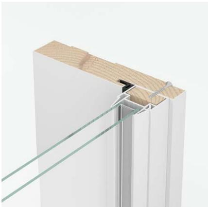
Cadre de fenêtre latérale de PVC extrudé avec renforcement en bois qui facilite l'installation. Parclose intérieure. Plusieurs modèles de fenêtres offerts.
